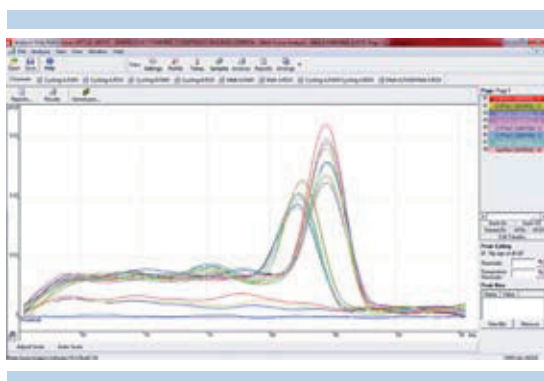
Figura 8. Ejemplo de curvas Melt, donde se aprecia la diferencia entre puntos de desnaturalización por calor de los diferentes componentes; en este caso, CYP1A1 en el pico menor y GAPDH en el más alto.
